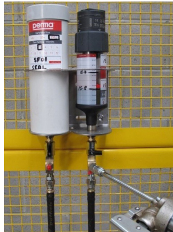
Llene las líneas de manguera con grasa limpia empleando la válvula de purga manual o la consola de soporte
