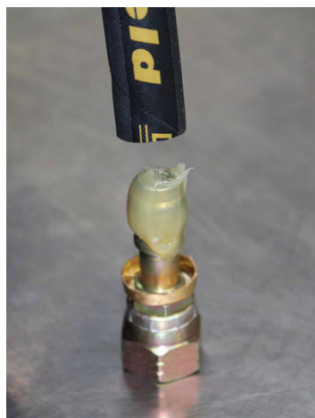
Appliquez de la graisse sur les extrémités du flexible avant de le faire glisser sur le raccord
