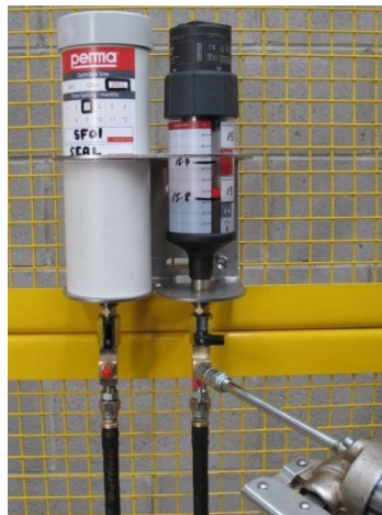
Remplissez les flexibles de lubrifiant frais en utilisant la soupape de purge ou la console de renfort
